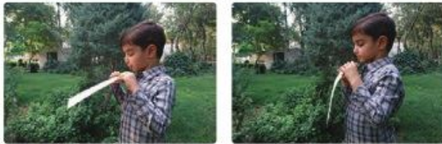
شکل ۲-۲۷: تندی جریان هوا در بالای کاغذ بیشتر از زیر آن است. یا توجه به اصل برنولی، فشار هوا در بالای کاغذ کمتر از زیر آن است.
