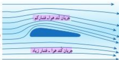
شکل ۲-۲۸: کاربرد اصل برنولی در بال هواپیما برای ایجاد نیروی رو به بالا.
