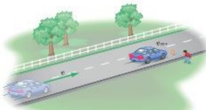
شکلی ۳-۸ وقتی خودرویی ترمز می‌گیرد د کار نیروهایی که بر خلاف جهت جابه‌جایی خودرو به آن وارد می‌شوند، انرژی جنبشی خودرو را کاهش می‌دهند.
