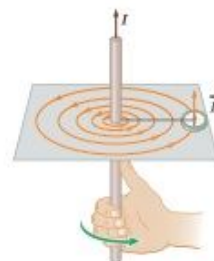
شکل ۱۵-۳ قاعده دست راست برای تعیین جهت \vec{B} اطراف سیم بلند مستقیم حامل جریان.
