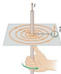
شکل ۱۵-۳ قاعده دست راست برای تعیین جهت \vec{B} اطراف سیم بلند مستقیم حامل جریان.
