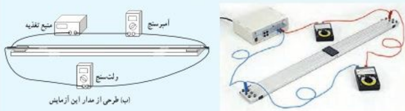
الف) اسباب آزمایش اندازه‌گیری مقاومت یک سیم رسانا
