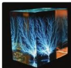
شکل ۱-۴۵ نقش‌های لیچنبرگ. فروریض الکتریکی باعث تشکیل مسیرهای رسانشی رخس‌شکلی در دی الکتریک شده است.
