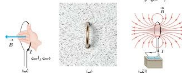
شکل ۱۷-۳ (الف) خط‌های میدان مغناطیسی در اطراف یک حلقه حامل جریان. (ب) طرح خط‌های میدان مغناطیسی یک حلقه حامل جریان با استفاده از براده آهن. (پ) استفاده از قاعده دست راست برای تعیین جهت \vec{B} یک حلقه حامل جریان.
