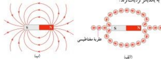
شکل ۶-۳ الف) تعیین جهت میدان مغناطیسی به کمک عقربه مغناطیسی. (ب) خط‌های میدان مغناطیسی در هر نقطه در جهت عقربه مغناطیسی اند و از قطب N خارج و به قطب S وارد می‌شوند. (در این شکل خط‌های درون آهنربا نشان داده نشده است.)
