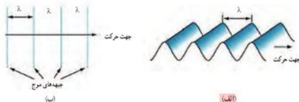
شکل ۱۳-۱۷ (الف) طرحی از تشکیل جبهه‌های موج تخت بر سطح آب یک تست موج. (ب) جبهه‌های موج، در روشی مناسب برای نمایش یک موج پیش‌رونده هستند. در رسم جبهه‌های موج معمولاً جبهه‌های مربوط به قله‌ها را رسم می‌کنند.
