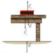
شکل ۸-۲: بر جسم نیروی عمودی سطح ( F_N ) و وزن ( \vec{W} ) وارد می‌شود.
