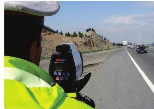
شكل ۳-۳ تعیین تندی خودروها به کمک اثر دوپلر
