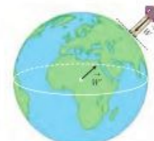
شکل ۲-۴: وزن یک جسم نیروی گرانشی ( \vec{W} ) وارد می‌کند و جسم نیز بر زمین نیروی گرانشی ( \vec{W}^* ) وارد می‌کند.
