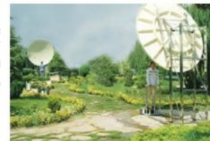
شکل ۴-۸ الف) دو سطح بازتابنده کاور در یک پارک تفریحی و ب) طرحی از بازتاب امواج صوتی از دو سطح کاور مقابل هم با استفاده از نمودار پرتویی
