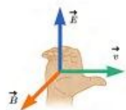
شکل ۳-۱۳: قاعده دست راست برای یافتن جهت انتشار موج الکترومغناطیسی
