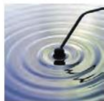
شکل ۱۳-۱۶ تشکیل امواج دایره‌ای بر سطح آب یک تست موج
