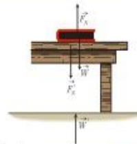
شکل ۸-۲: بر جسم نیروی عمودی سطح ( F_N ) و وزن ( \vec{W} ) وارد می‌شود.
