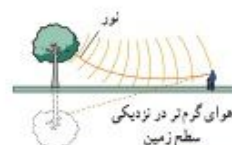
شکل ۴-۲۱ مدل‌سازی پدیده سراب به کمک جبهه‌های موج. ناظری که برتوهای نور در پدیده سراب به چشم می‌رسد، گمان می‌برد که این برتوها از یک تصویر آمده‌اند.
