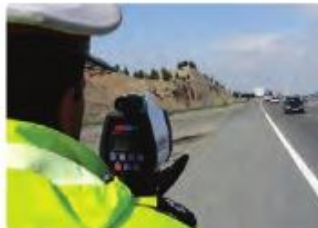
شكل ۳-۳ تعیین تندی خودروها به کمک اثر دوپلر
