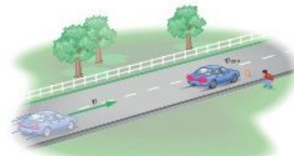
شکل ۳-۹ وقتی خودرویی ترمز می‌گیرد کار نیروهایی که بر خلاف جهت جابه‌جایی خودرو به آن وارد می‌شوند، انرژی جنبشی خودرو را کاهش می‌دهند.
