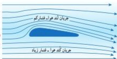
شکل ۲۸-۲ کاربرد اصل برنولی در بال هواپیما برای ایجاد نیروی رو به بالا.
