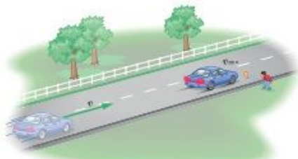
شکل ۳-۸ وقتی خودرویی ترمز می‌گیرد کار نیروهایی که بر خلاف جهت جابه‌جایی خودرو به آن وارد می‌شوند، انرژی جنبشی خودرو را کاهش می‌دهند.
