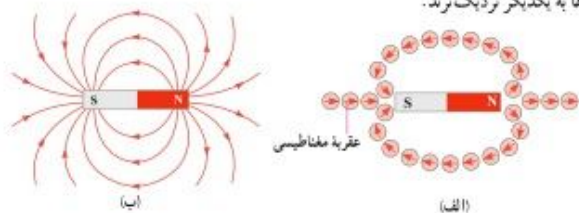
شکل ۳-۳ الف) تعیین جهت میدان مغناطیسی به کمک عقربه مغناطیسی. ب) خط های میدان مغناطیسی در هر نقطه در جهت عقربه مغناطیسی اند و از قطب N خارج و به قطب S وارد می شوند. در این شکل، خط های درون آهنربا نشان داده نشده است.
