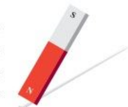
شکل ۱-۳-۴ وقتی یکی از قطب‌های یک آهنربای دائمی را چندین بار و در یک جهت به یک سوزن نهد که بکنید، سوزن برای مدتی دارای خاصیت مغناطیسی می‌شود.
