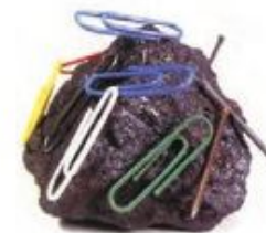
شکل ۱-۳-۱ سنگ آهنربای طبیعی. تالس که اغلب از او به عنوان پدر علم یونان یاد می‌شود، ماده کانی مگنتیت Fe_3O_4 را که ویژگی آهنربایی دارد می‌شناخت.
