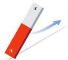
شکل ۱-۳-۴ وقتی یکی از قطب‌های یک آهنربای دائمی را چندین بار و در یک جهت به یک سوزن نهد که بکنید، سوزن برای مدتی دارای خاصیت مغناطیسی می‌شود.
