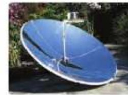
شکل ۳-۱۳۶ (الف) یک موج الکترومغناطیسی تخت پس از بازتاب از یک سطح کاو در نقطه‌ای مقابل سطح کائونی می‌شود. (ب) تصویری از یک اجاق خورشیدی
