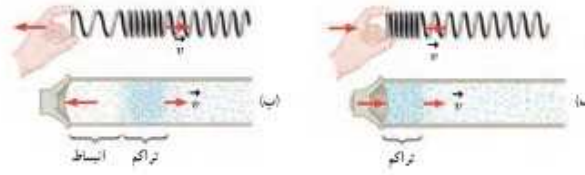
شکل ۳-۲۴ الف) با حرکت رو به بیرون دیافراگم، یک تراکم ایجاد می‌شود. ب) با حرکت رو به داخل دیافراگم، یک انبساط ایجاد می‌شود. این تراکم و انبساط نتیجه به جمع‌شدگی و بازشدگی در یک فنر بلند است.
