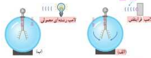
شکل ۴-۱ الف) برهم‌کنش نور فرودی فرابنفش با کلاهک برق‌نما سبب می‌شود تا ورقه‌های آن به سرعت به هم نزدیک شوند. ب) در حالی که برهم‌کنش نور مرئی گسیل‌نده از یک لامپ رشته‌ای تغییری در انحراف ورقه‌های برق‌نما به وجود نمی‌آورد.
