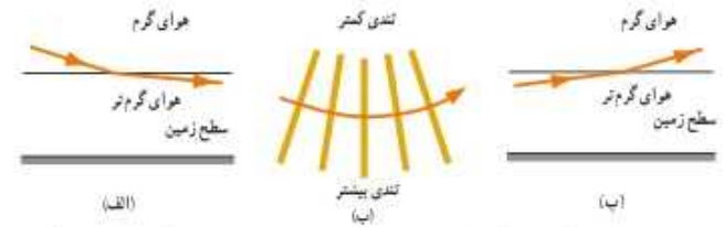
شکل ۳۳-۵: خمیدگی امواج امیز یک بر روی تور که در امتداد یک مرز فرضی از هوای گرم به سمت هوای گرم تر پایین می‌رود. با تغییر جبهه‌های موج و خمیدگی مربوط به آن، به این دلیل رخ می‌دهد که انتهای پایین جبهه‌های موج در هوای گرم‌تر سریع‌تر حرکت می‌کنند. ب) خمیدگی امواج امیز یک بر روی تور که در امتداد یک مرز فرضی از هوای گرم‌تر به سمت هوای گرم بالا می‌رود.
