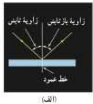
شکل ۳-۳۷ (الف) در هر بازتابشی زاویه تابش و زاویه بازتابش با هم برابرند. (ب) برنوی تابش، برنوی بازتابش، و خط عمود بر سطح بازتابنده در یک صفحه واقع‌اند.
