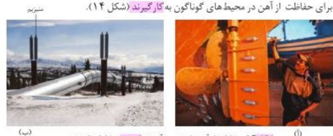
شکل ۱۴ - حفاظت از آهن با منیزیم، (آ) بدنه گشتی (ب) لوله‌های نفتی
