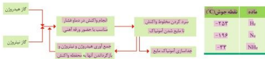
نمودار ۲. نمای تولید آمونیاک در صنعت به روش هابر
