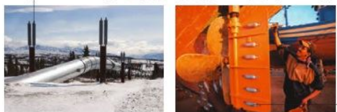
شکل ۱۴. حفاظت از آهن با منیزیم، (آ) بدنه کشتی، (ب) لوله‌های نفتی
