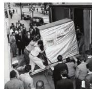
شکل ۱- راست: انتقال حافظه ۵ مگابایتی شرکتی بی‌ام. پیشرفته‌ترین سخت‌افزار روز جهان در سال ۱۹۵۶؛ این حافظه را از نظر اندازه، ظرفیت و قیمت با حافظه‌های امروزی مقایسه کنید. چپ: یک حافظه ۲ ترابایتی امروزی
