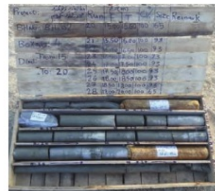
شکل ۶-۴ حفز مغزه‌گیری توسط گمانه‌های اکتشافی
