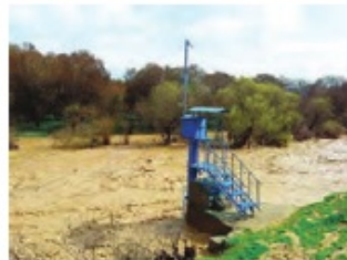
شکل ۳-۲. ایستگاه اندازه‌گیری آبدهی رود
